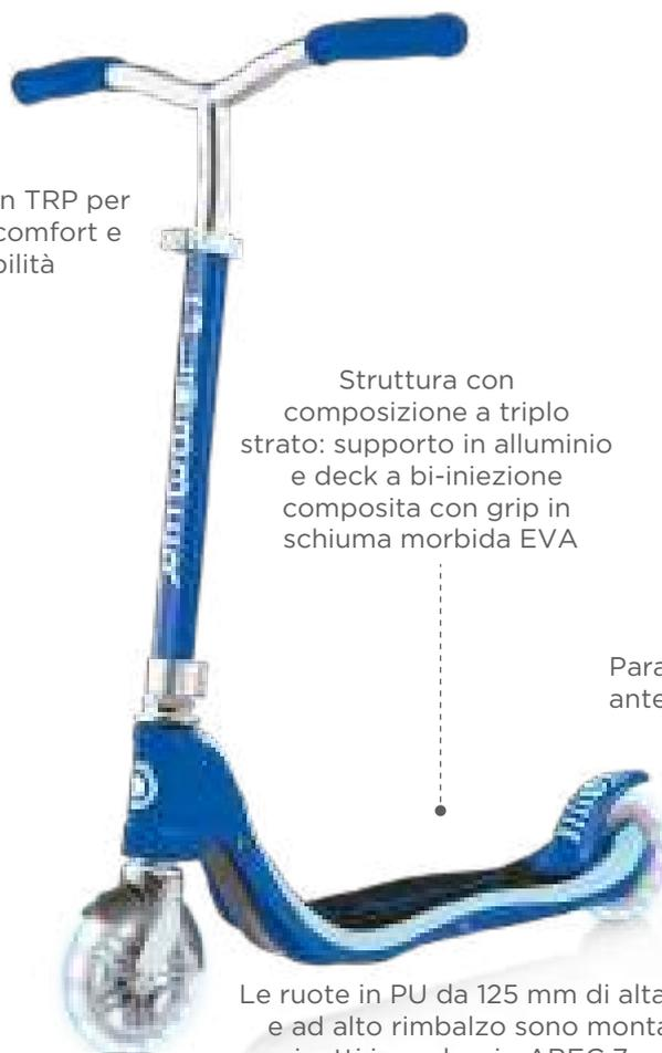
Struttura con composizione a triplo strato: supporto in alluminio e deck a bi-iniezione composita con grip in schiuma morbida EVA
