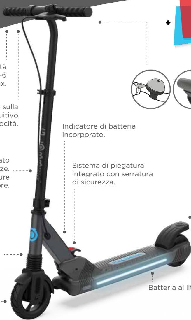
Impostazioni della modalità di velocità integrate: 0-6 km/h max; 0-15 km/h max.
