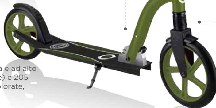
T-bar in alluminio anodizzato curvo, largo e regolabile a 3 altezze: 101,5, 106,5 e 111,5 cm
