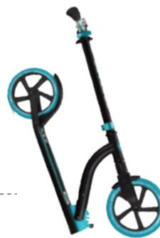
Sistema di piegatura brevettato. È sufficiente sollevare il pulsante verso l'alto per mettere lo scooter in modalità trolley autoportante.
